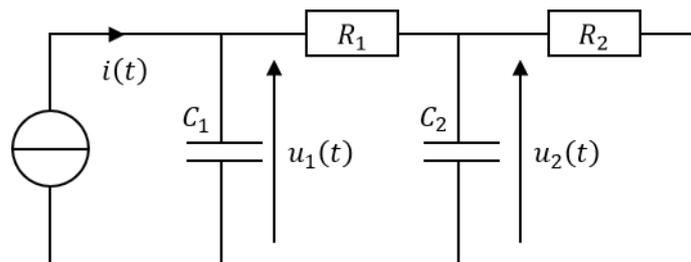
2) Que devient ce circuit électrique en régime permanent continu ? Exprimer alors la tension  $u_2(t \rightarrow \infty)$  en fonction, entre autres, de  $u_1(t \rightarrow \infty)$ .
